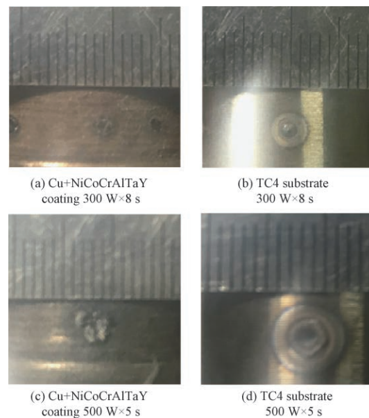
图 7 激光烧蚀后 TC4 基体及 Cu+NiCoCrAlTaY 涂层表面形貌
